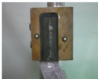
图12 复合材料风扇叶片破坏位置 Fig.12 Failure position of the composite fan blade
